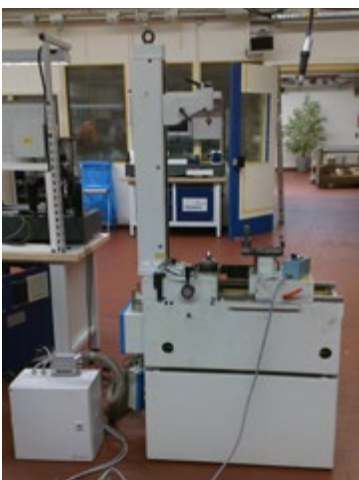
Höfler ZW300 before retrofitting
